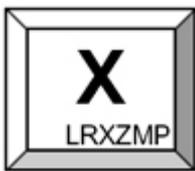
Die **Quorion** Touchscreen - Kassen verfügen über kein Kontrollschloss. Die Betriebsarten werden mit Hilfe der Multiplikationstaste alternierend zwischen **L - R - X - Z - M - P** umgeschaltet. Die Berechtigungen werden in diesem Fall über spezielle Bedienerflags programmiert.
